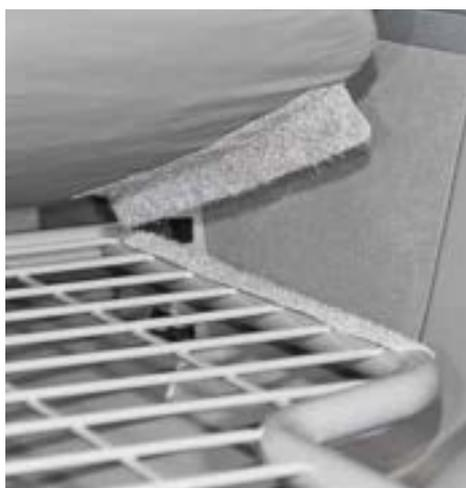
iXTEND PAD se fixe avec un scratch auto-collant à la rallonge de lit, dans le coin avant et sur les côtés (« couvre-coffre en bois » jusqu'à l'année modèle 2010, « tête grille » à partir de 2011 / 2015). Si l'on utilise iXTEND PAD en guise de protection sur le sur-matelas iXTEND ouvert, il faut simplement presser les fixations scratch autocollantes contre iXTEND PAD pour que la bande munie de crochets ne frotte pas au-dessous.
