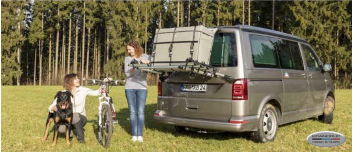
Malle arrière FLEXBAG Cargo pour porte-bagages VW. Fixation très robuste par 3 sangles de polyester avec boucles d'arrimage en aluminium avec came à griffes auto-bloquantes, plus fixation latérale particulièrement solide en six points d'attache.
