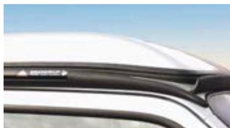
Le spoiler avant dirige parfaitement l'écoulement de l'eau de pluie et réduit les bruits de vent dans le toit relevable : conduite plus silencieuse.
