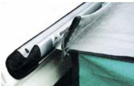
Le spoiler arrière a une ouverture pour introduire un bourrelet. Avec TOP-RAIL fermé à l'avant, pas de sifflements en roulant et moins de dépôts sales.
