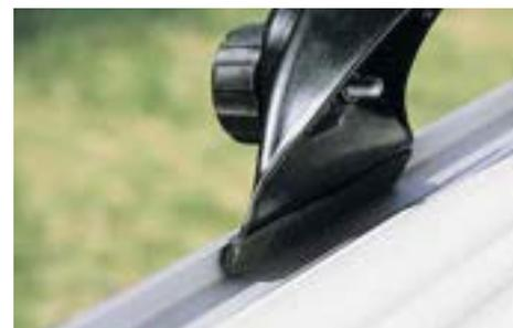
Un « conseil » pour le TOP-RAIL : de bonnes galeries universelles de marque offrent moins de résistance au vent et génèrent moins de bruits aérodynamiques que les galeries ordinaires des véhicules sans gouttière pluviale. Sur les toits bas hauteur du pied de fixation de 14 et 20 cm pour toits relevables.
