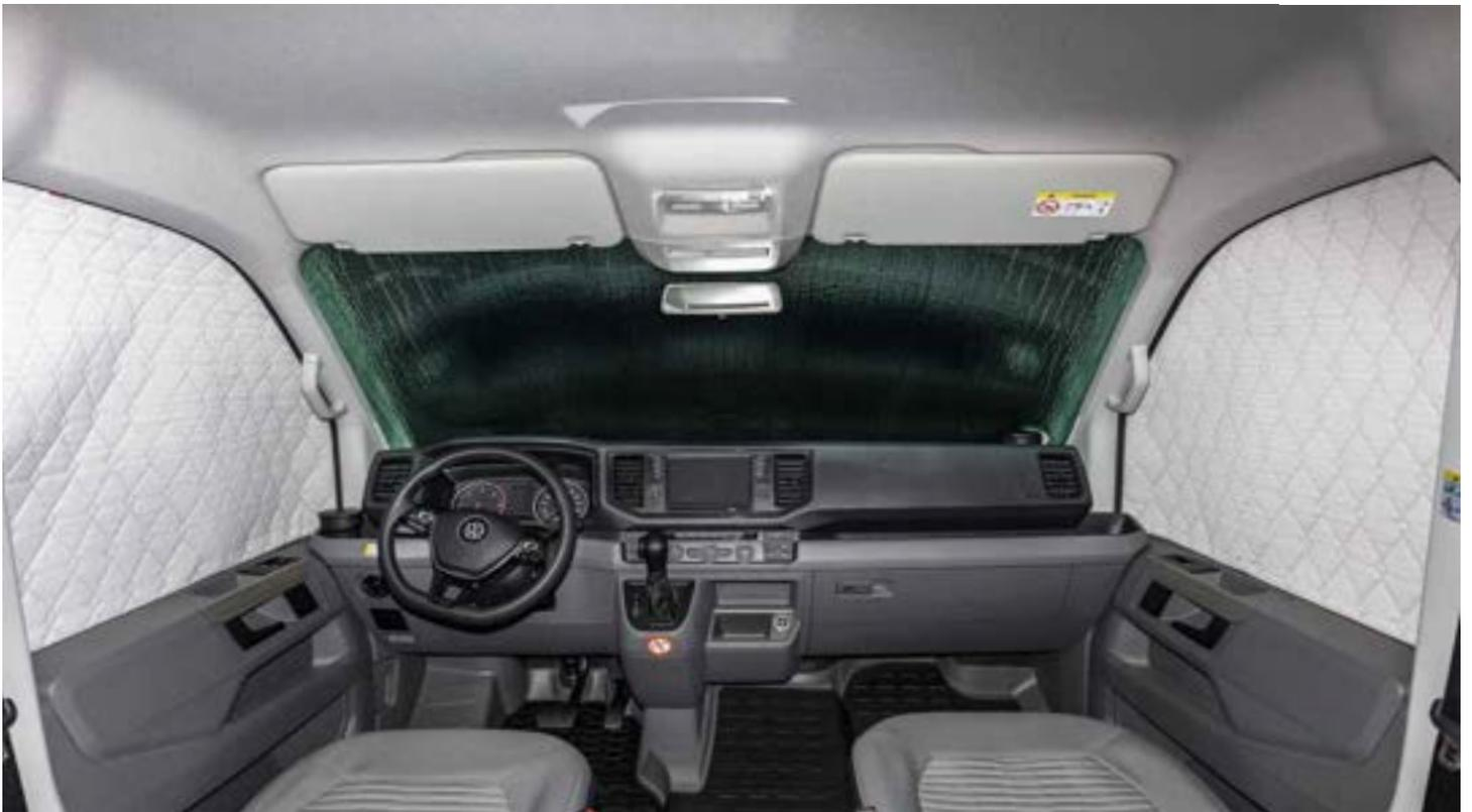
ISOLITE Outdoor Plus Extreme se compose d'un écran ISOLITE Outdoor pour l'extérieur du pare-brise ainsi que de deux panneaux ISOLITE-Extreme pour l'intérieur des fenêtres latérales, qui produisent un effet d'optique élégant et agréable, et une
