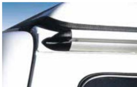
La pièce de finition arrière souligne l'harmonie des lignes et dérive l'eau de pluie vers le bas par le côté, l'empêchant de couler dans l'arrière ouvert.
