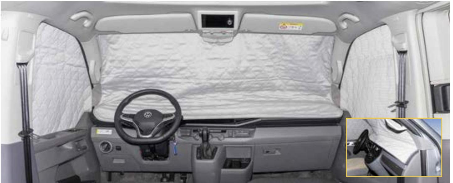
ISOLITE Extreme assure l'isolation optimale du pare-brise : à un panneau d'ISOLITE Inside plaqué contre la vitre, est fixé contre lui côté intérieur un second panneau d'ISO-TOP Extreme, qui emprisonne entre les deux un grand coussin d'air isolant.
