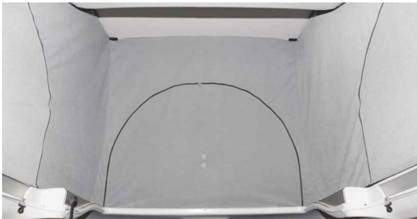
La protection ISO-TOP est toujours prête à l'emploi, et reste posée dans le toit sans qu'il soit nécessaire de la décrocher : Elle se replie d'elle-même lorsqu'on referme le toit. Les fenêtres latérales d'ISO-TOP peuvent rester closes lorsqu'on ferme le toit pour
