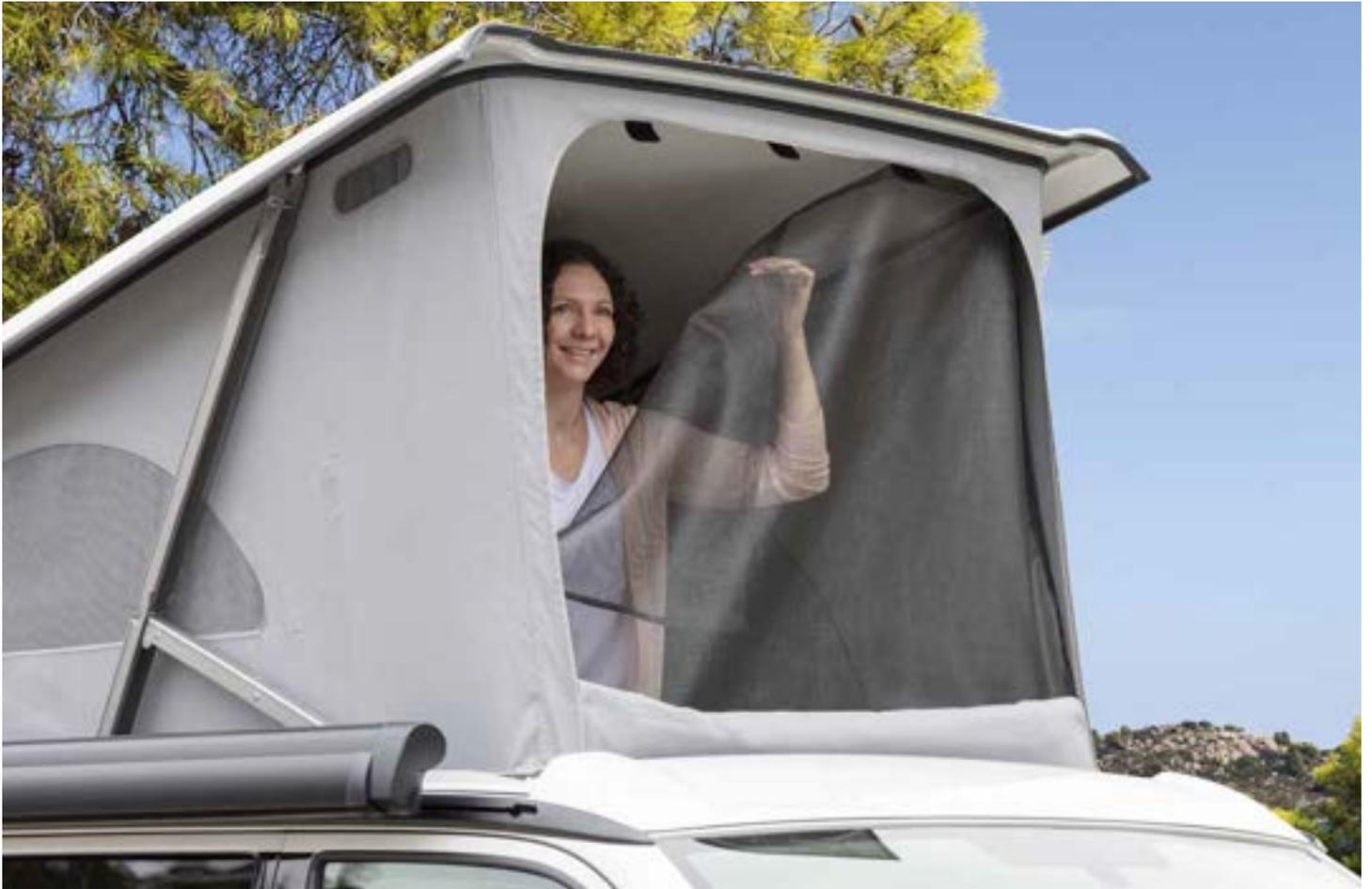
Il est possible d'équiper ISO-TOP MK VI postérieurement d'une moustiquaire FLYOUT. FLYOUT s'installe dans la grande ouverture frontale d'ISO-TOP MK VI par une fermeture à glissière et se bloque en haut sur les rectangles de scratch de la fixation de l'ISO-TOP.
