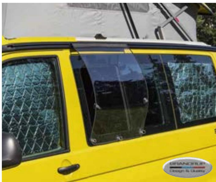
AIRSCREEN pour les T6 et T5 VW est fabriqué avec un carreau en polycarbonate de très grande qualité (« Makrolon® »).
