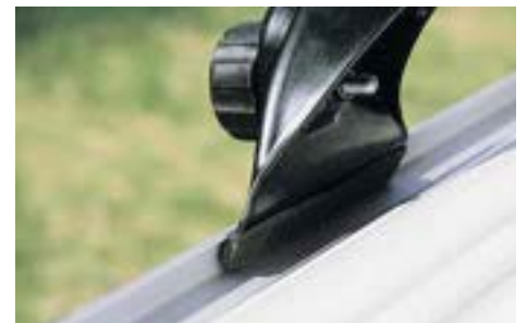
Der Trägerfuß stützt sich seitlich und unten im Regenrinnenprofil gut ab. Trotzdem gibt es keinen Wasserstau: Das Regenwasser fließt gut ab.
