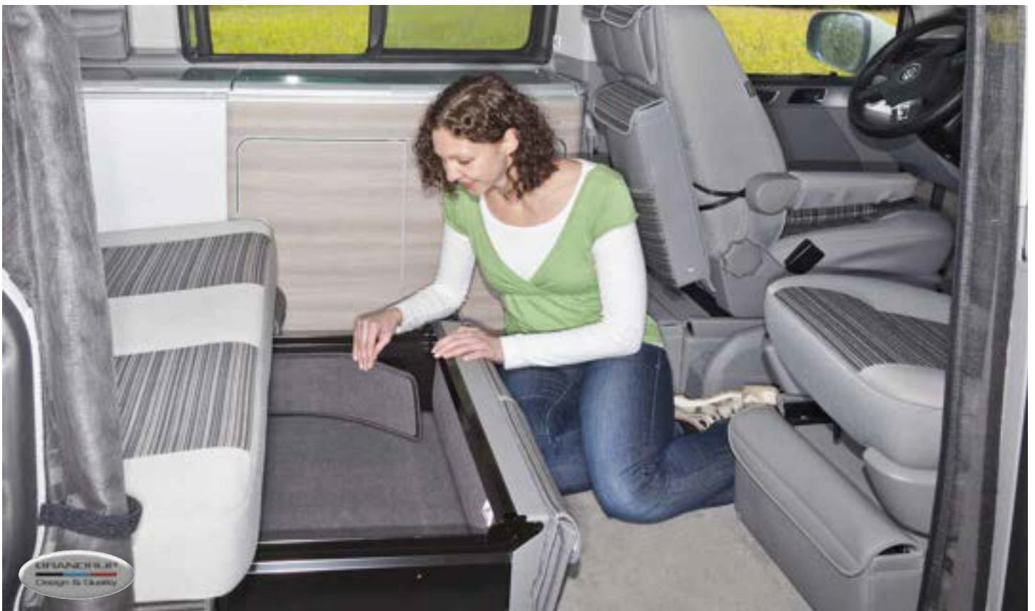
Geräuschdämm-Matte und -Set California T6.1/T6/T5: Sind ideal zur „Beruhigung“ der Blechschublade unter dem Bett (2er-Sitz-bank): Abgelegte Sachen „klappern“ nicht mehr und sind besser geschützt. Die Markisenkurbel kann weiterhin eingeklipst werden. Die Geräuschdämm-Matte (Boden) wird in die Schublade eingelegt. Das Geräuschdämm-Set (Seitenteile) hat oben Klettverschluss.
