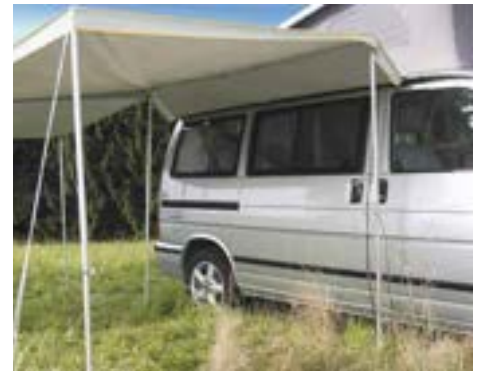
Abbildung rechts: Der waagrechte Hochstellstab wird mit einem Aufstellstabsatz am TOP-SAIL angebracht.
